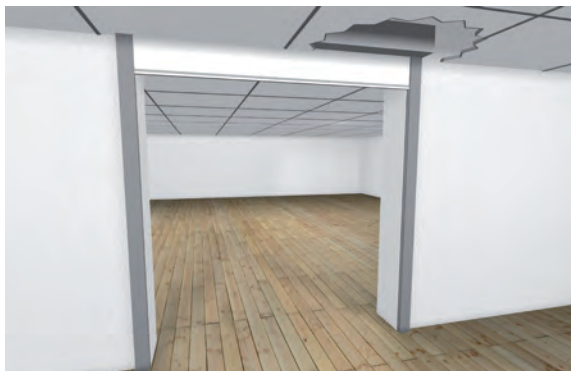
Montering av kassett ovanför innertak och montering av styrskenor på vägg
