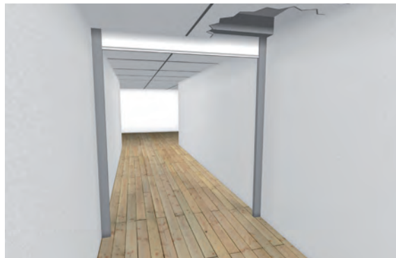
Dold montering av kassett i korridor och synliga styrskenor
