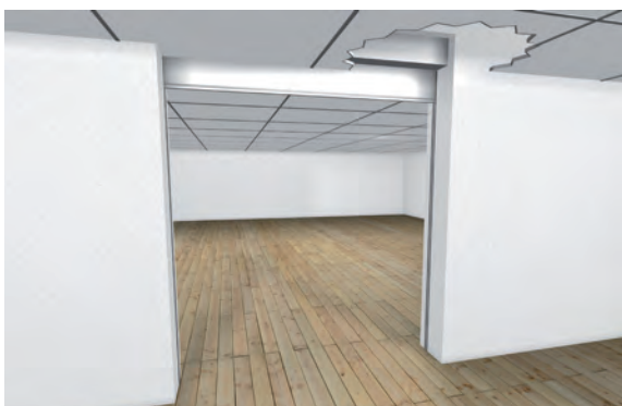
Dold montering av kassett ovanför innertak och styrskenor i öppning
