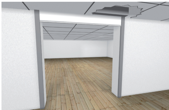
Montering av kassett ovanför innertak och montering av styrskenor på vägg
