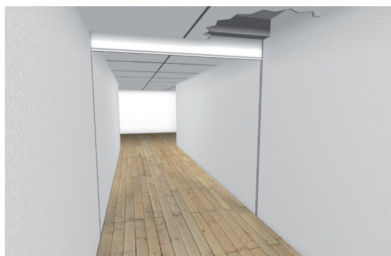
Dold montering av kassett och styrskenor i korridor
