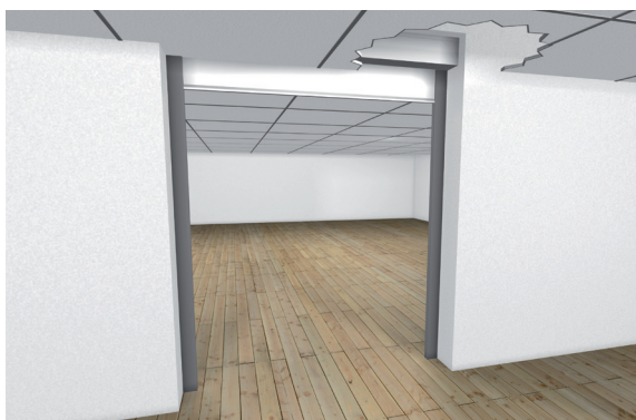
Dold montering av kassett ovanför innertak och synlig montering av styrskenor i öppning
