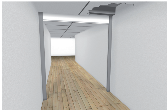
Dold montering av kassett i korridor och synliga styrskenor
